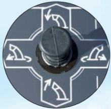
**Joystick** zur Steuerung von Auswurfkamin und Auswurfklappe
