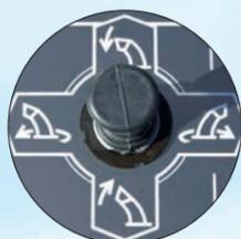
Orientamento elettrico del camino e posizione del deflettore regolabile tramite **joystick**
