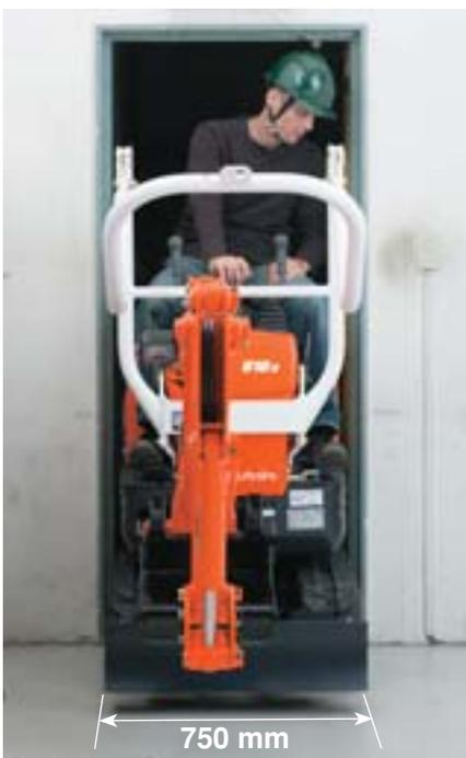
Bei der eingestellten Fahrwerksbreite von nur 750 mm kann der sich U10-3 durch fast jede Tür, z. B. in Innengebäuden bewegen.
