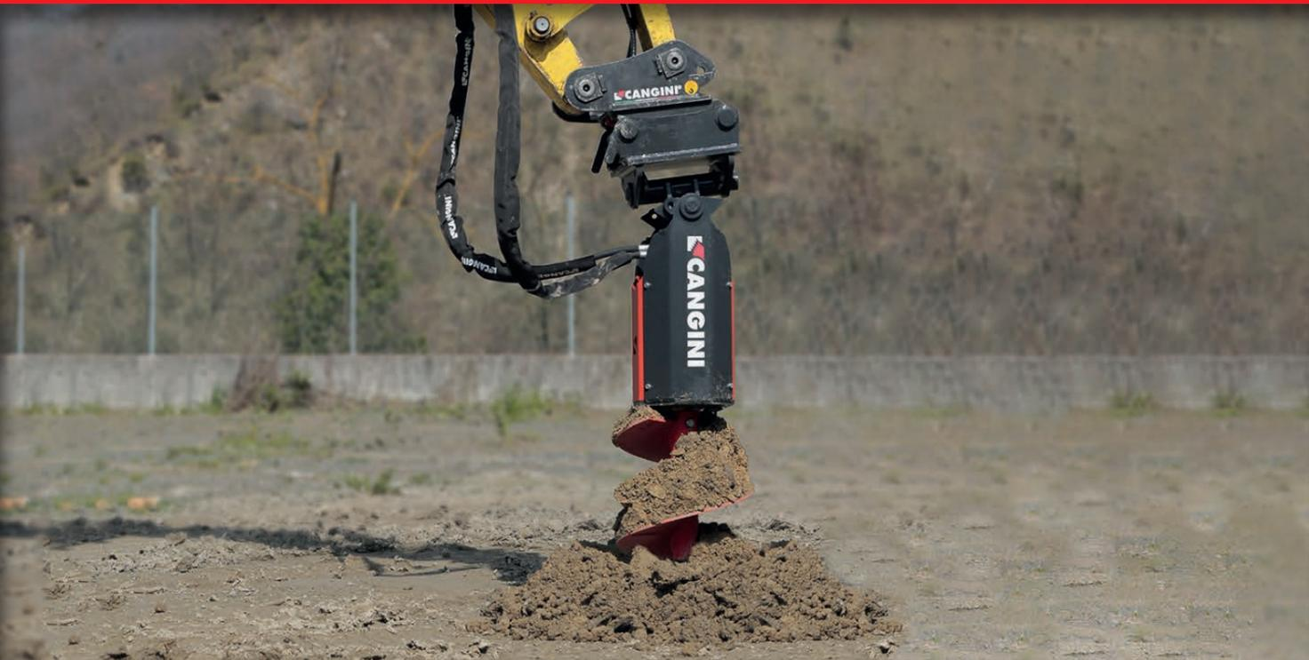
LA TRIVELLA IDRAULICA BIDIREZIONALE MONTA UNA TRASMISSIONE CON RIDUTTORE EPICICLOIDALE E DOPPIO SNODO DI SERIE. IL RIDUTTORE È PROTETTO DA UN INVOLUCRO IN ACCIAIO CHE LO PRESERVA DA URTI.
