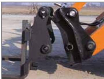
**L'Aggancio Rapido M3** senza modifica della benna originale permette di utilizzare qualsiasi tipo di attrezzatura eliminando completamente i tempi lunghi di sostituzione delle stesse. E' applicabile a tutte le terne, evita qualsiasi tipo d'intervento in officina e aumenta sensibilmente la produttività della macchina.
