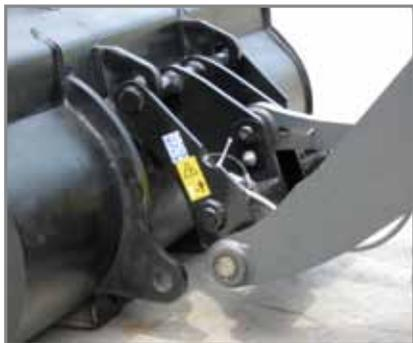
**L'Aggancio Rapido M3** con modifica della benna originale non sposta il baricentro della macchina lasciando inalterata la capacità di carico e la forza di strappo.
