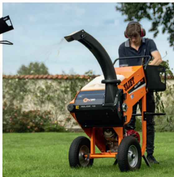
ELIET ha sviluppato e brevettato un sistema di cippatura unico, il **principio Ascia™**. Come un'ascia, le lame tagliano in direzione delle fibre a 48.000 movimenti di taglio al minuto. I rifiuti verdi vengono trasformati in un ciclo di divisione e taglio in piccoli frammenti **Biotech™** a rapido compostaggio.
