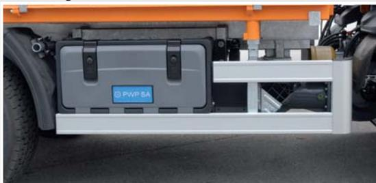
*Unterfahrerschutz bei LKW-Betrieb vorgeschrieben, auf Wunsch mit Werkzeugkiste*
