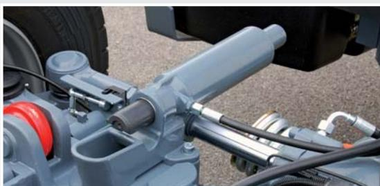
*Hydraulischer Schnellverschluss (Option)*
