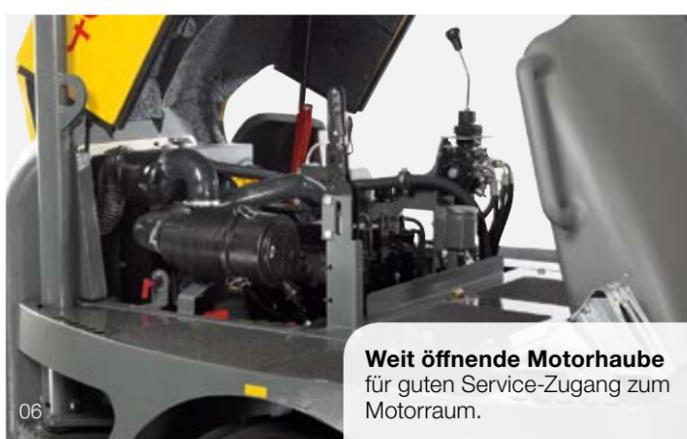
**Weit öffnende Motorhaube** für guten Service-Zugang zum Motorraum.
