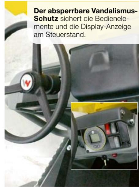
Der absperrbare Vandalismusschutz sichert die Bedienelemente und die Display-Anzeige am Steuerstand.
