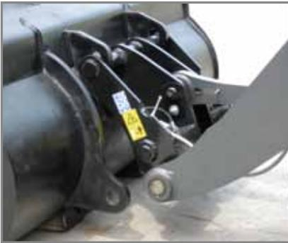
**Der M3 Schnellwechsler** mit Änderung der Originalschaufel lässt die Arbeitseigenschaften der Maschine und den Gewichtsschwerpunkt unverändert; Füllmenge und Ausbrechkraft bleiben gleich.
