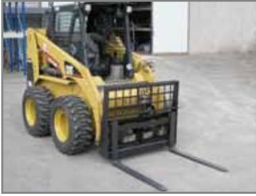
**Die M3 Palettengabel** kann an jeder Art Kompaktlader - Baggerlader - Radlader angebracht werden. Sie wird mit unterschiedlicher Hubkraft von 1000 bis 7000 kg gebaut. Auf Anfrage auch mit Hubkraft bis 30.000 kg.
