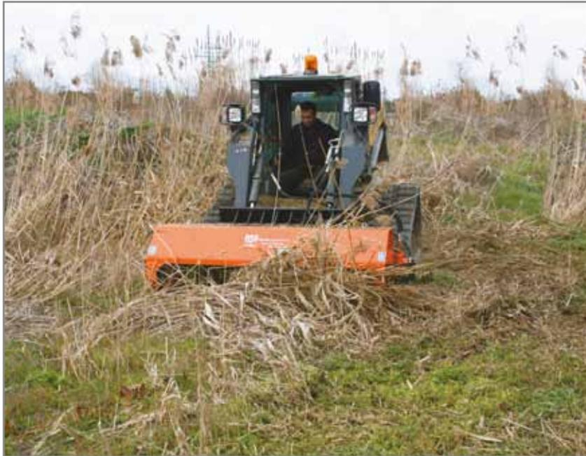
Die Schlegelmulcher MDC sind äußerst stabil gebaut und sind ausdrücklich für den Einsatz auf Kompaktladern mit einem Ölstrom von mindestens 75 l/min. gedacht.
