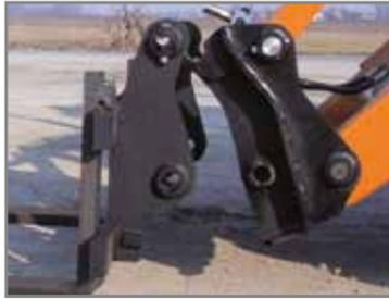
**Der M3 Schnellwechsler** ohne Änderung der Originalschaufel kann an jeder Art Baggerlader angebracht werden. Die langen Zeiten zum Auswechseln der Ausrüstungen, die auf der Maschine verfügbar sind, fallen weg. Die Produktivität wird merklich gesteigert.
