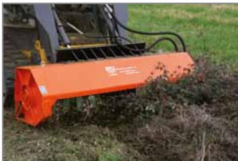
Alle Schlegelmulcher der MDC Serie sind mit einem Paar "Y" Messern sowie einem dritten Messer in der Mitte ausgerüstet. Das mittlere Messer zerkleinert das Material zusätzlich.
