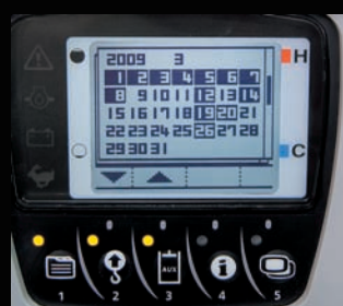
Sistema di registrazione delle operazioni
