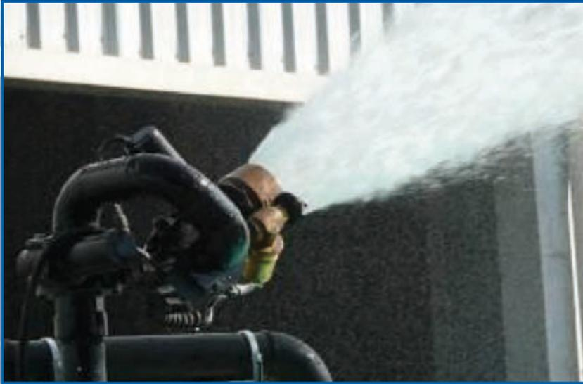
Il nebulizzatore non è solo la migliore soluzione per ridurre la polvere ma è anche una soluzione amica dell'ambiente. I sistemi tradizionali utilizzati durante le demolizioni possono consumare fino a 300 l / m. Con il nebulizzatore basta il consumo di acqua è compreso fra 12 e 53 l / m in base al modello. Questo significa consumi di acqua ridotti al minimo, migliori risultati e rispetto delle risorse naturali.
